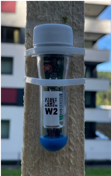
Abbildung 20: (rechts) SHT31 mit Strahlungsabschirmung, befestigt auf 2 m Höhe am Standort W2
